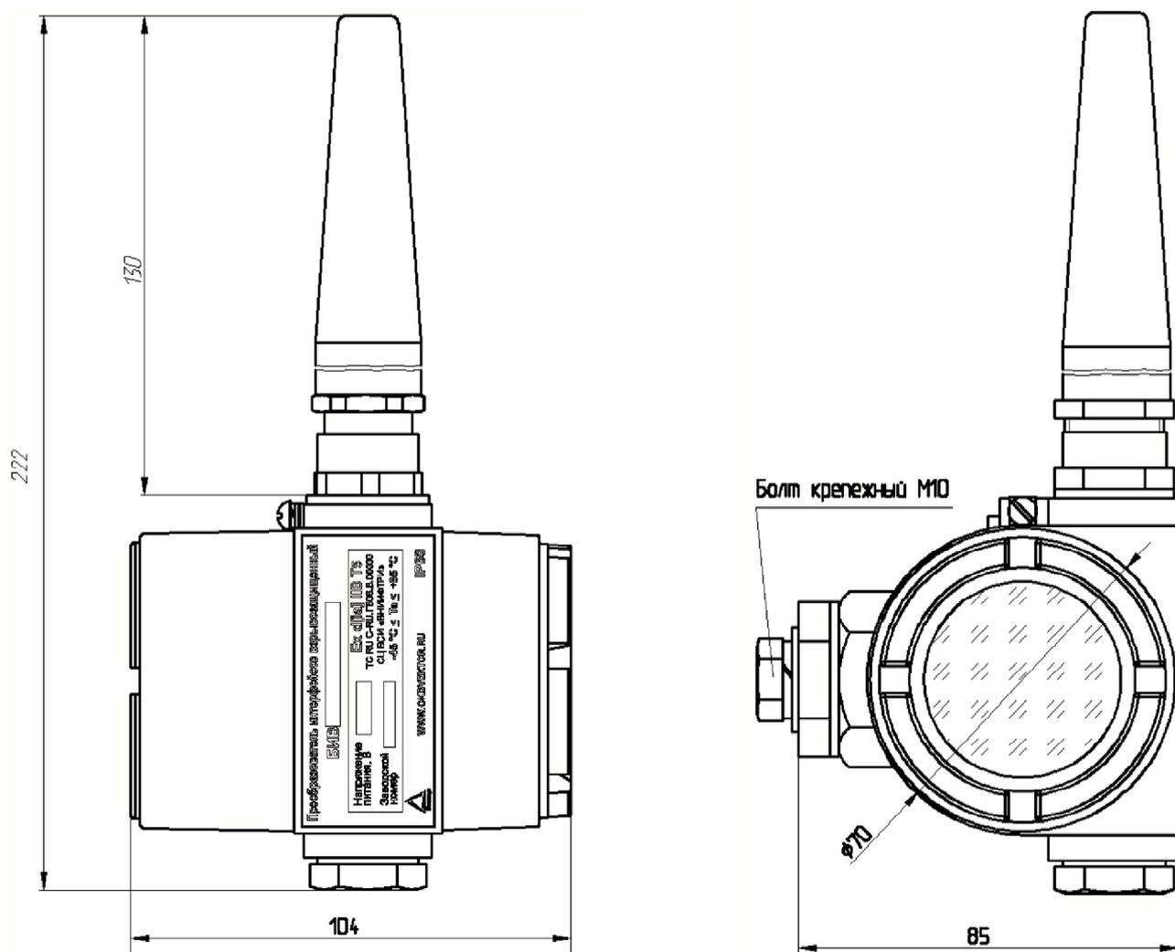
Рисунок В.3 Габаритные размеры БИВ2 – UART/ISM868.
