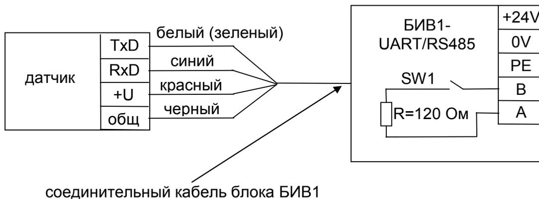
Рисунок С.2 Схема подключения БИБ1-UART/RS485 к первичному преобразователю (датчику).
