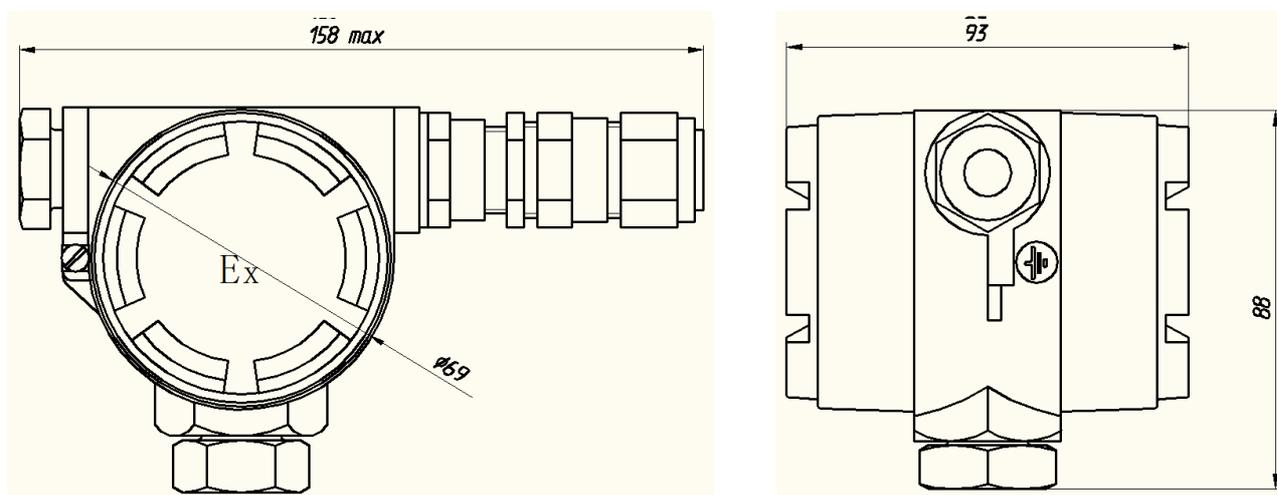
Рисунок В.1 Габаритные размеры БИВ1-UART/RS485.
