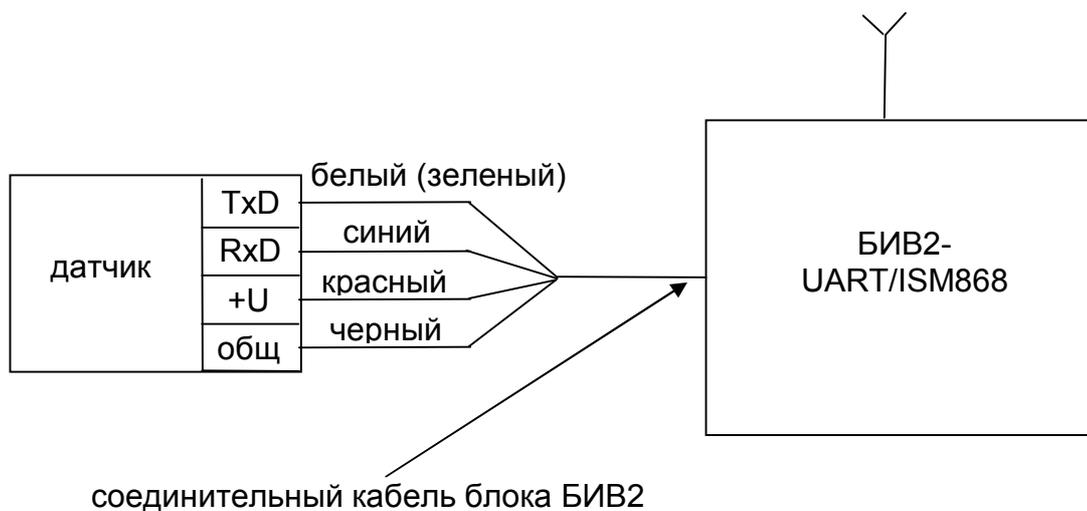
Рисунок С.3 Схема подключения БИВ2-UART/ISM868 к первичному преобразователю (датчику).
