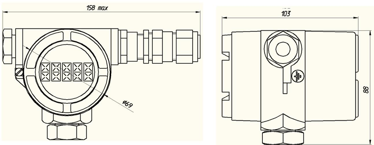
Рисунок В.2 Габаритные размеры БИВ1-UART/RS485-Д.
