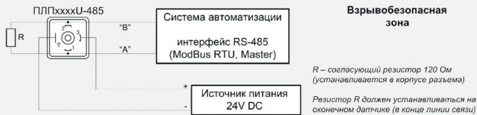
Схема подключения датчика типа ПЛПxxxxH
